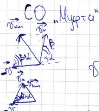
Компоненты троса должны двигаться с одинаков. скор., а то он порвал бы.
