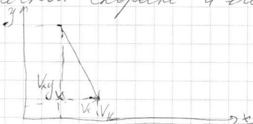
По т. Пифагора найдем  $V_{ky} = \sqrt{V_x^2 + V_k^2} = \sqrt{400 \text{ м}^2/\text{с}^2 - 16 \text{ м}^2/\text{с}^2} = 8\sqrt{6} \text{ м/с} \approx 19,2 \text{ м/с}$
